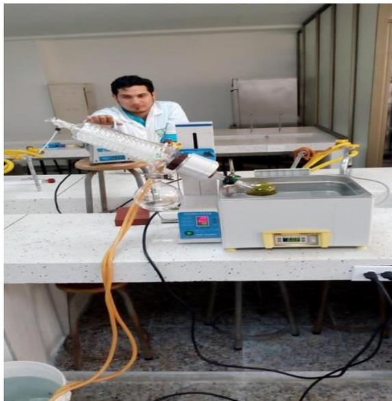
**Figura No. 10.** Montaje del proceso de rotaevaporación
