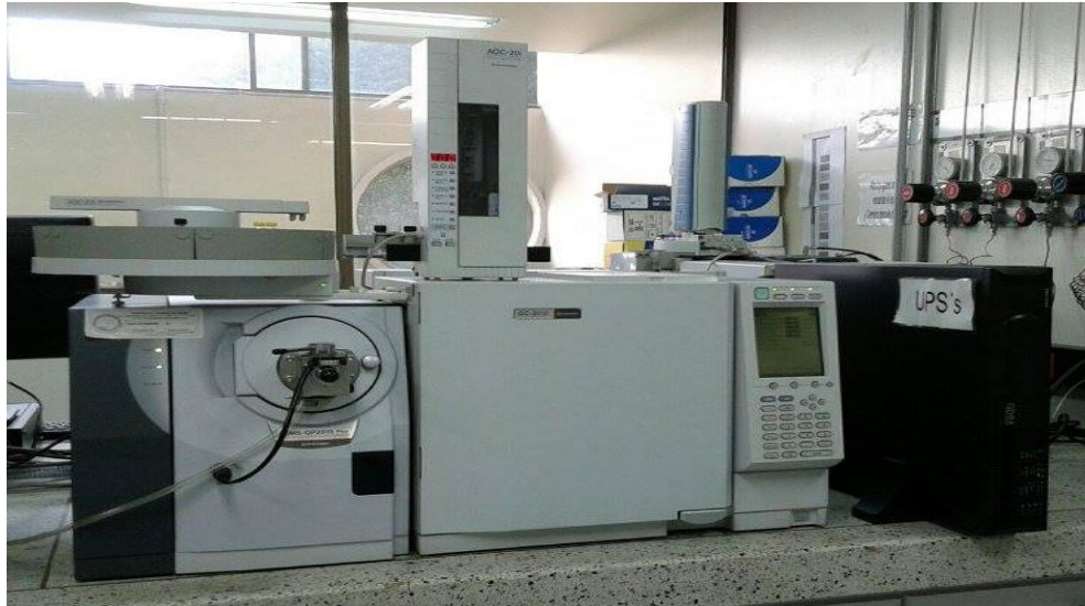
Figura N.4: cromatógrafo de gases acoplado a espectrometría de masas de la universidad de caldas
