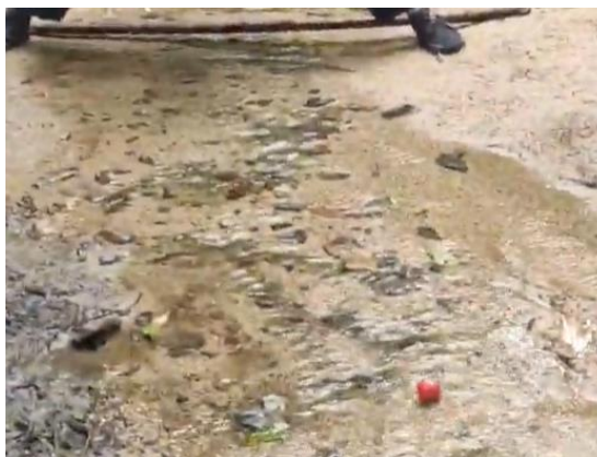
Imagen 9 Método del flotador para medición de caudal en arroyo final
