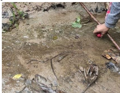
Imagen 8 Método del flotador para medición de caudal en arroyo inicio
