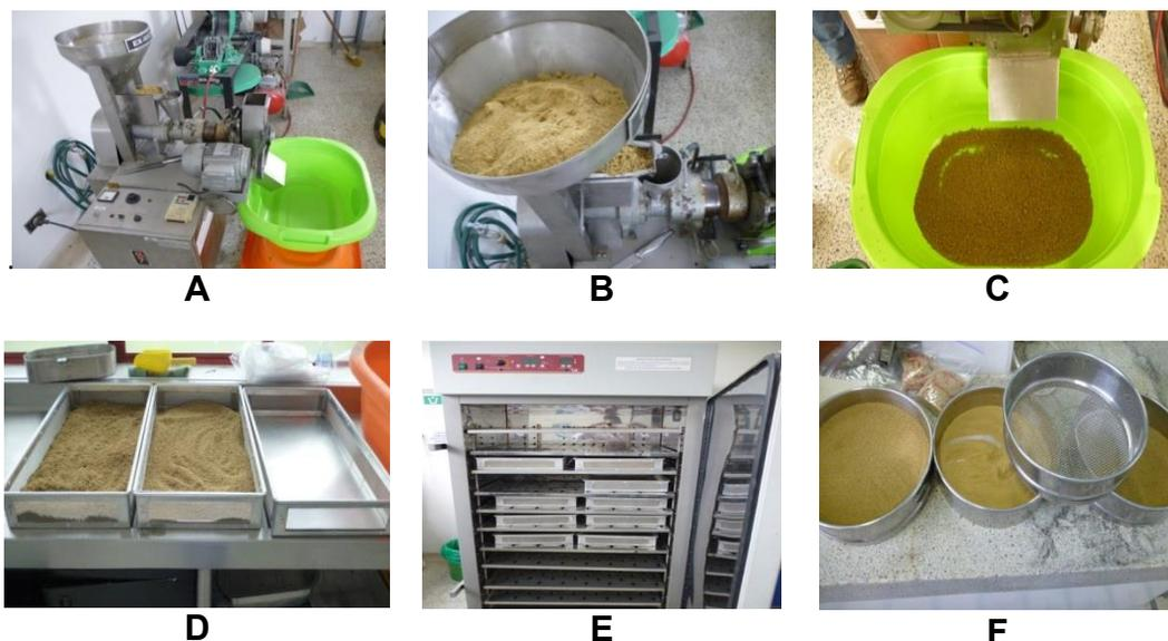
**Figura 8.** Proceso de extrudizado de las dietas ya elaboradas. A) Equipo microextrusora listo para iniciar el proceso, B) Ubicación de la mezcla lista para extrudizar, C) Recepción en cubeta del producto ya extrudizado, D) Distribución de la dieta en capas delgadas sobre bandejas para llevar al horno, E) Acomodación de las bandejas con las dietas para el proceso de secado, F) Tamizaje de las dietas por tamaños.
