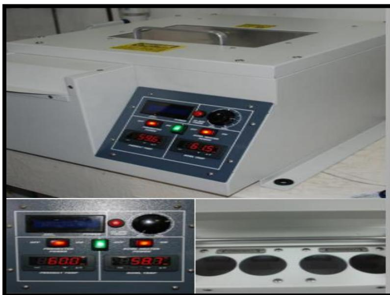
Figura 5. Fotografía de Centrifuga para la determinación de agua y sedimentos en petróleo. Fuente. (Autores).
