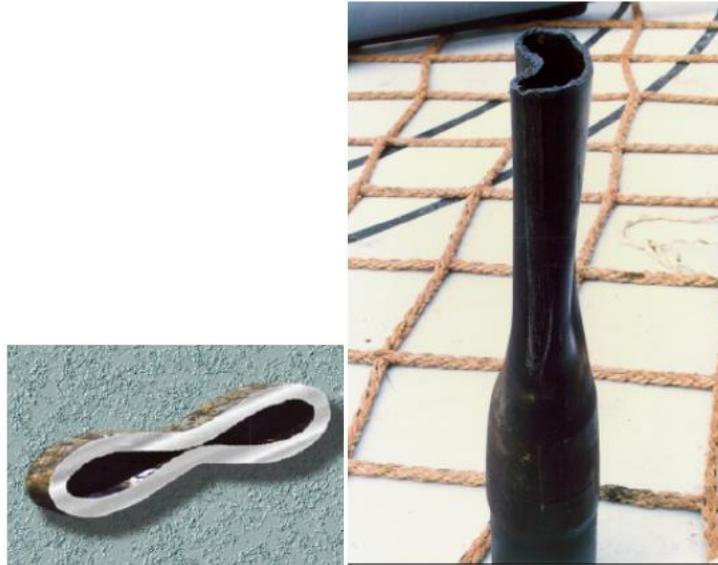
Fig 3. 2 Tubería afectada por colapso. Fuente: (Morales, 2010)
