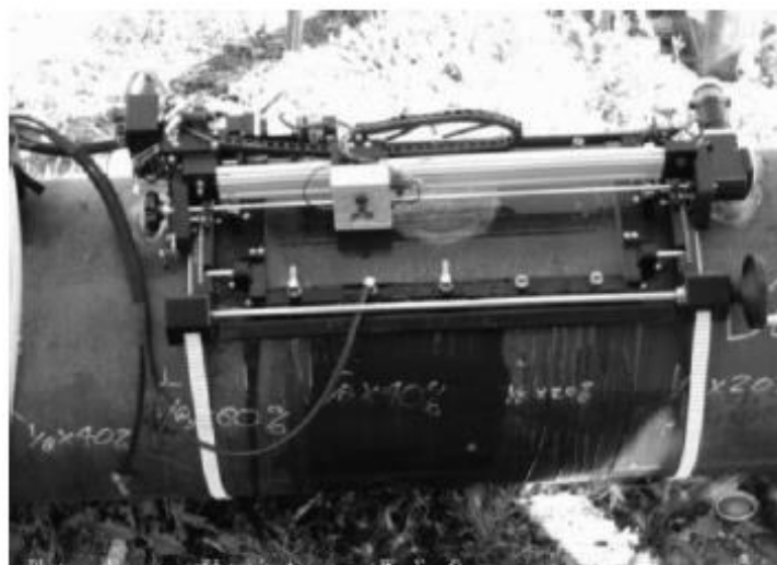
Ilustración 15 Equipo para ultrasonido por inmersión
