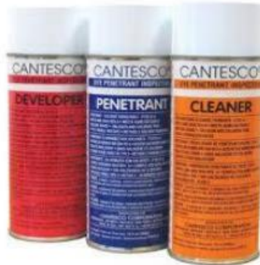
Ilustración 9 Clases de líquidos penetrantes
