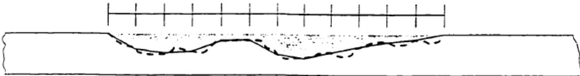
Ilustración 21 Área proyectada por ASME B31G
