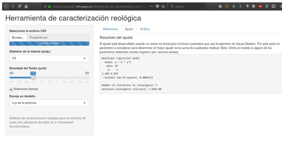
Figura 3.8: Vista de la herramienta de caracterización reológica: Análisis de regresión.
