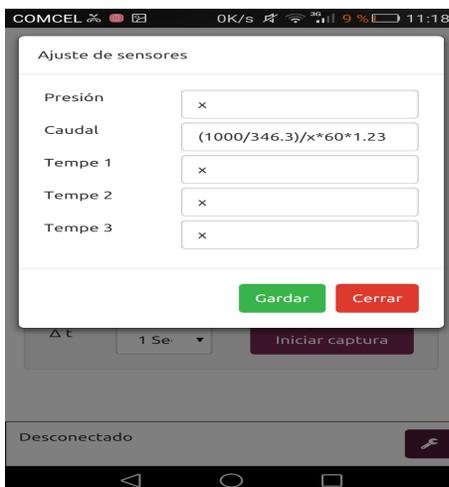
Figura 3.5: Ajuste de calibración de los sensores.
