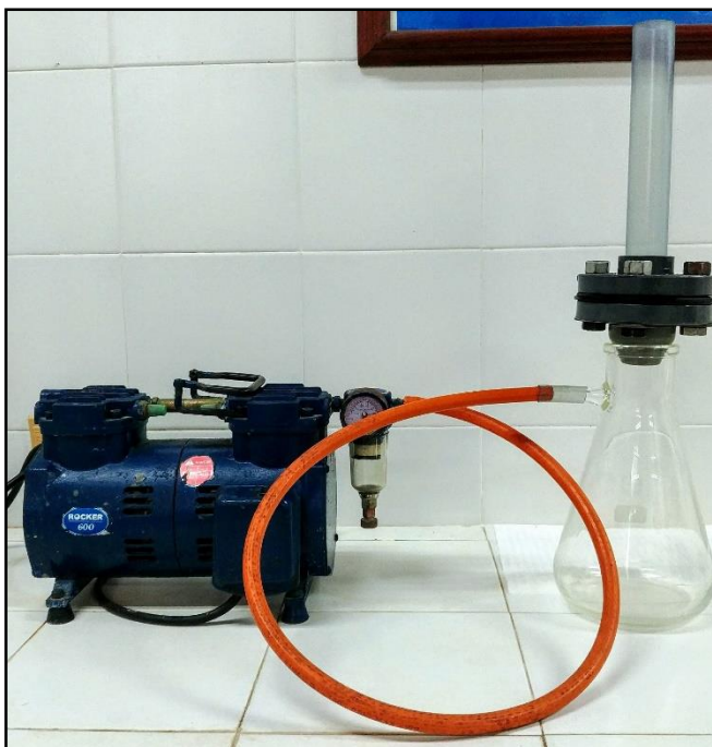
Figura 25. Montaje experimental evaluación separación emulsiones de aceite en agua
