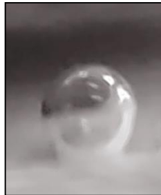
Figura 24. Detalle oleofobia membrana modificada (gota de cloroformo en medio acuoso) ángulo de contacto aprox. 137^\circ .
