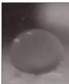
Figura 29. Gota de cloroformo sobre sección de cedro tratada (ángulo de contacto aprox 163^\circ )
