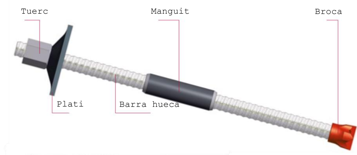
Figura 2-4: Barra autoperforante DYWI® Drill. Modificado de (DSI, 2022).
