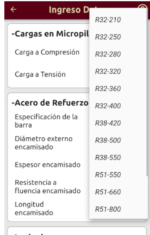
Ilustración 30. Entrada Especificación de la barra
