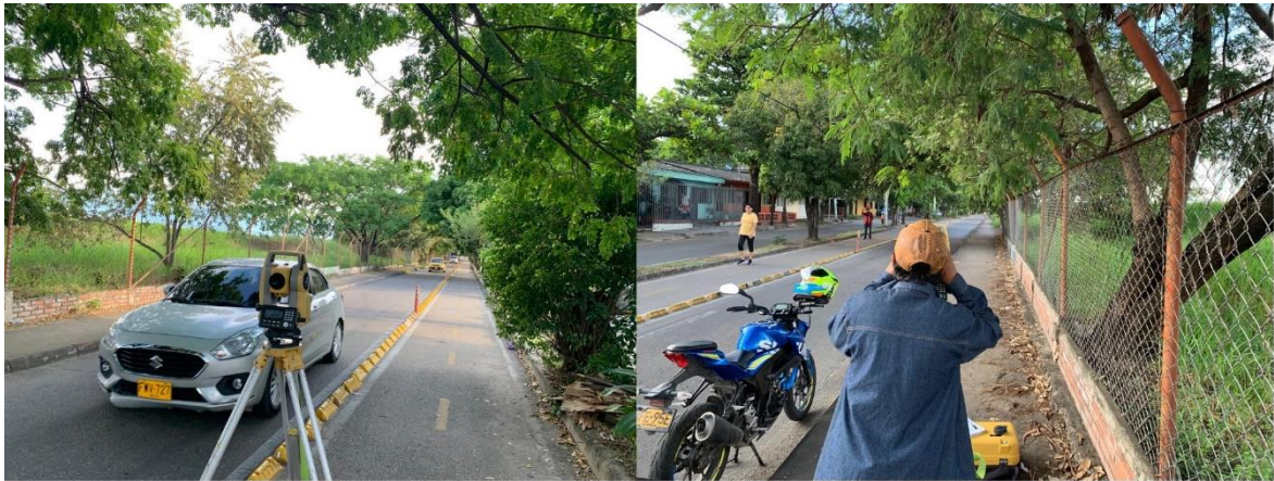
Figura 3-4: Trabajo de campo de topografía realizado con estación total.
