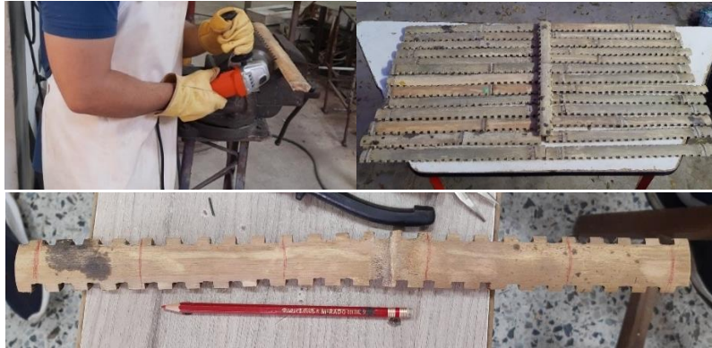
Figura 3-10: Realización de patrón de acanalado a los refuerzos de bambú.
