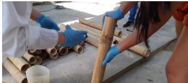
Figura 3-9: Inyección de Lorsban a los culmos de bambú.
