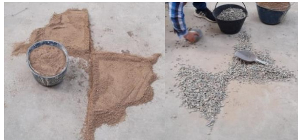
Figura 3-5: Cuarteo de agregados finos y gruesos.
