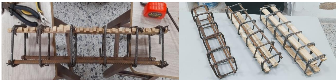
Figura 3-12: Amarre de refuerzos longitudinales y transversales; en la imagen derecha se aprecia el armazón en acero convencional, acero a compresión y bambú a tensión (BT) y bambú a tensión y compresión (BTC) respectivamente.
