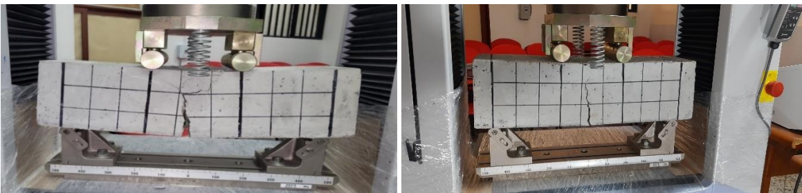
Figura 3-17: Montaje en la máquina universal de ensayos.
