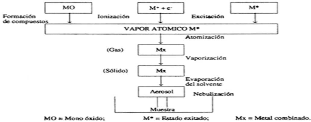
Figura 6. Esquema de la espectrofotometría de absorción atómica. Recuperado de: http://www.fao.org/docrep/field/003/ab482s/AB482S04.htm
