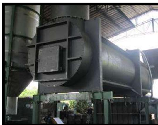
**Figura 3.** Cámara superior de combustión
