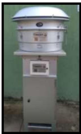
**Figura 7.** Muestreador de partículas de alto volumen
