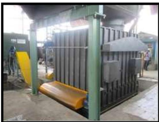
**Figura 2.** Cámara inferior de combustión
