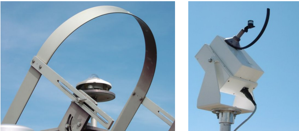
Figura 4-6. Piranómetros con distintos dispositivos de sombra para medida de la radiación difusa.
