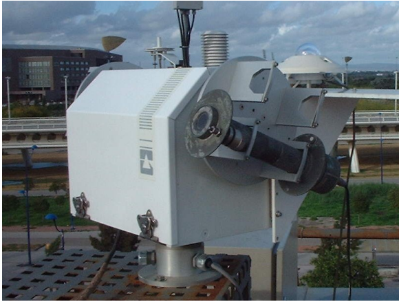
Figura 4-13. Pirheliómetro Eppley NIP montado sobre un seguidor solar.
