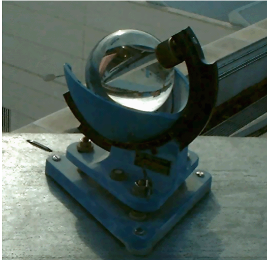
Figura 4-7. Heliógrafo de Campbell-Stokes instalado en la estación de medidas de la Escuela Superior de Ingenieros de Sevilla.
