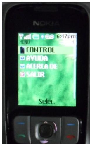
Las primeras pruebas se realizaron con el celular junto al módulo de control. El tiempo de búsqueda de dispositivos es de aproximadamente 8 segundos. Los comandos se pueden enviar las veces que el usuario lo desee, siempre y cuando todos se realicen dentro de la misma conexión.
